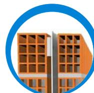
Détail de la finition Boltherm avec double lame d'air
